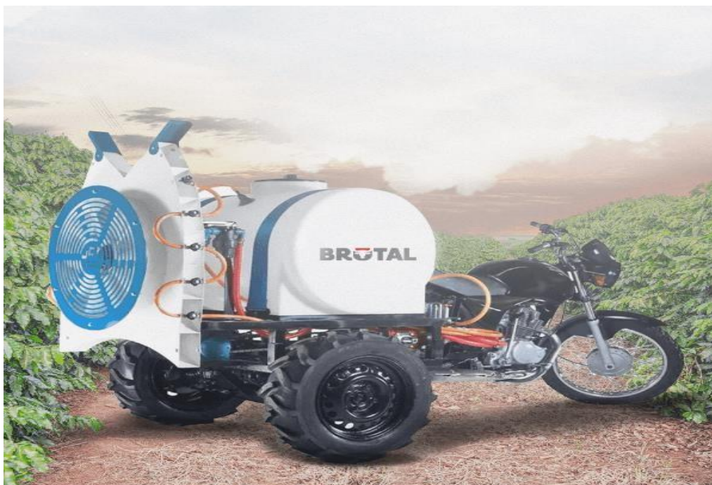
Figura 9. Imagem do triciclo agrícola utilizado para a pulverização da alavoura de maracujá com produtos fitossanitários via pulverização/atomização.
