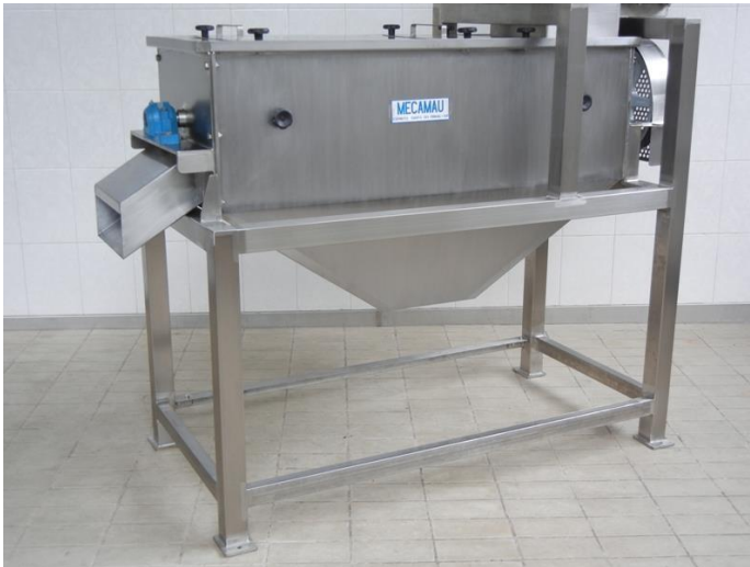
Figura 10. Equipamento elétrico de despolpa de frutos de maracujá (Despolpadeira).
