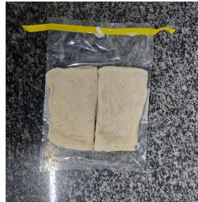
Figura 8 - Swab de arrasto utilizado.
