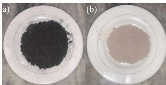
Figura 5 - Amostras de CME (a) antes do processo de requeima e (b) após o processo de requeima.
