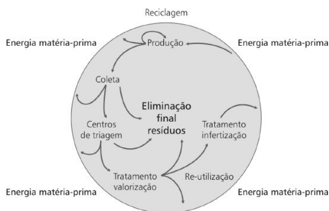
Figura 4 - Processos de aproveitamento de resíduo. Fonte: Adaptado de Rocha & Cheriaf (2003).
