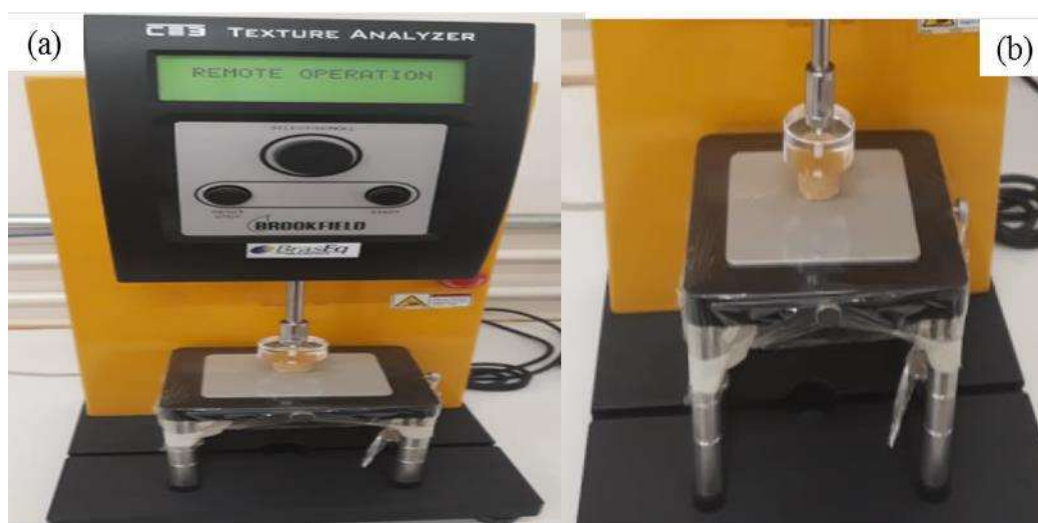
Figura 2. (a) Analisador de textura Brookfield, (b) corpo de prova durante o teste.
