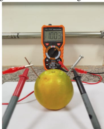
Figura 4 – Fotografia mostrando a montagem da biopilha de Daniel
