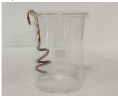
Figura 3 – Montagem da reação redox entre o fio de cobre e a solução de sulfato de prata
