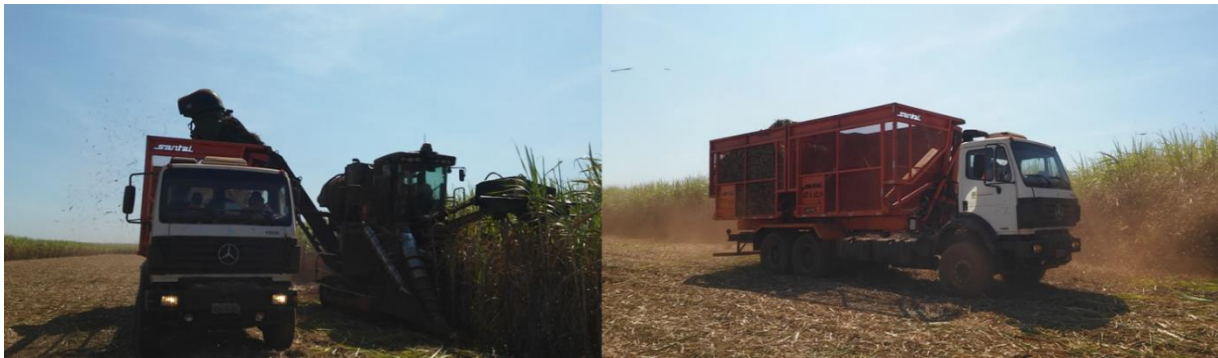
Figura 3. Colheita mecanizada com uso de caminhão instrumentado com célula de carga no chassi.
