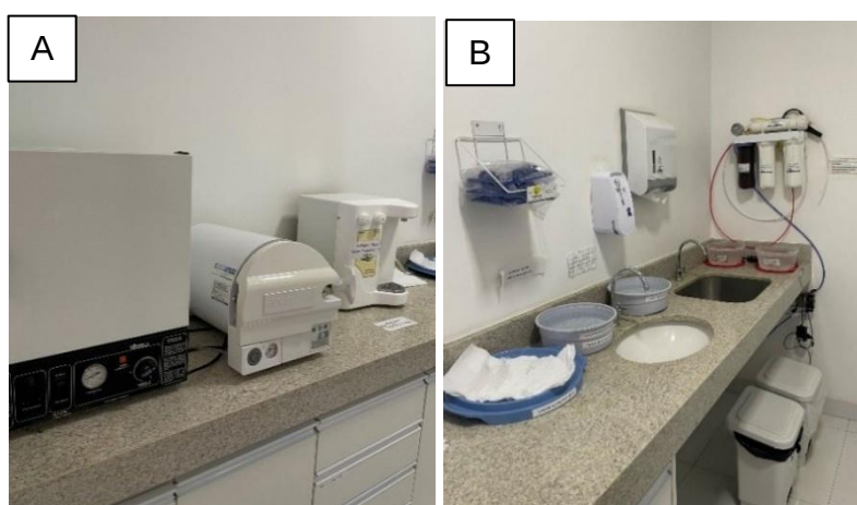
Figura 6 – Sala de lavagem e esterilização do laboratório Centro Diagnóstico Bueno. (A) Autoclaves. (B) Recipientes de limpeza das cubetas e o destilador de água. Goiânia – GO, 2023. Fonte: Arquivo pessoal.
