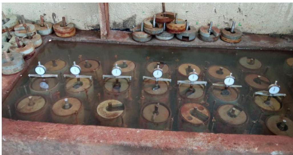
Figura 6. Submersão dos corpos-de-prova por 96h para ensaio de CBR. (Fonte: Autoria própria, 2025).
