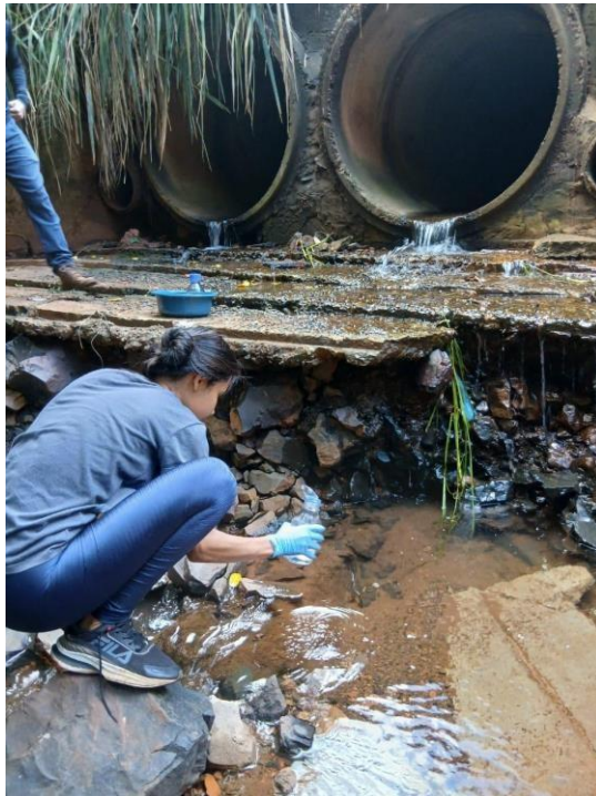
Figura 4: Amostragem de água em ponto de escoamento urbano para avaliação de DBO e DQO.
