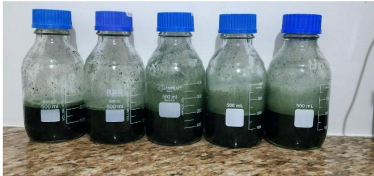
**Figura 11** – Frascos com solução resultante da fermentação líquida do fungo entomopatogênico *Metarhizium anisopliae*, utilizados para extração e formulação de bioinsumos. (Fonte: Autora)
