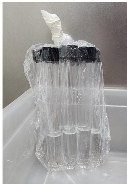
**Figura 2** – Tubos de ensaio esterilizados e embalados para manipulação asséptica. (Fonte: Autora)
