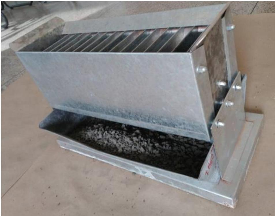
**Figura 2** – Separador de amostra agregado graúdo.
