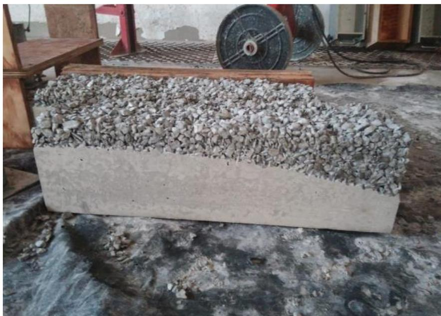
**Figura 11** – Corpo de prova com segregação.
