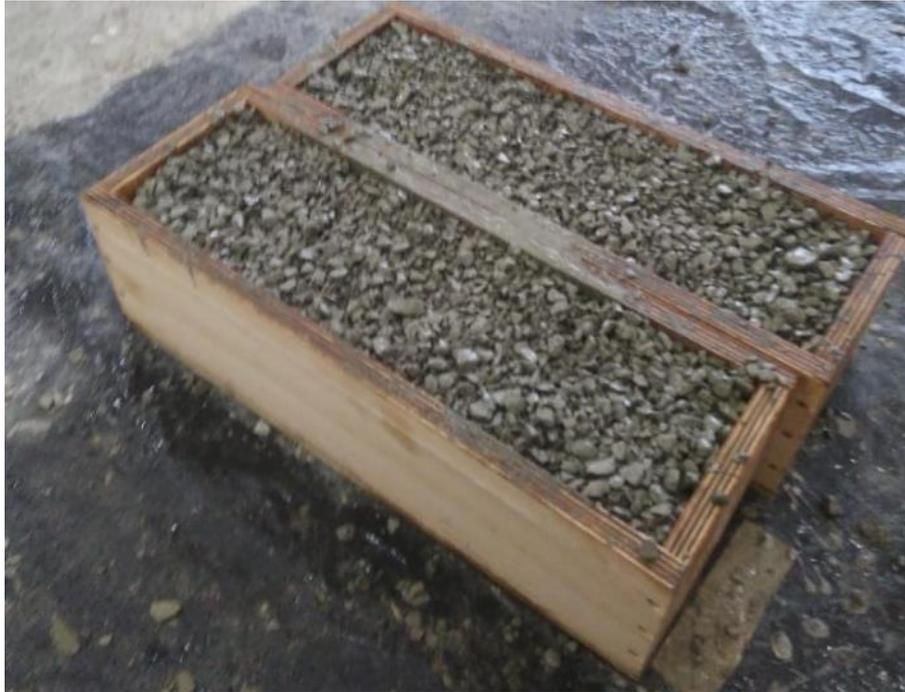
**Figura 10** – Formas prismáticas de compensado naval.
