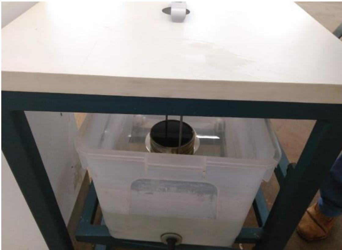
**Figura 9** – Aparatos pesagem submersa.
