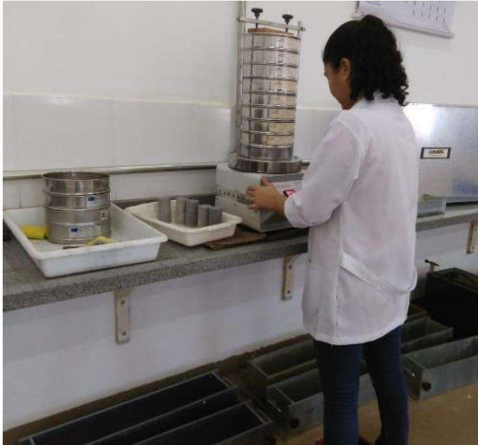
**Figura 3** – Agitador mecânico.
