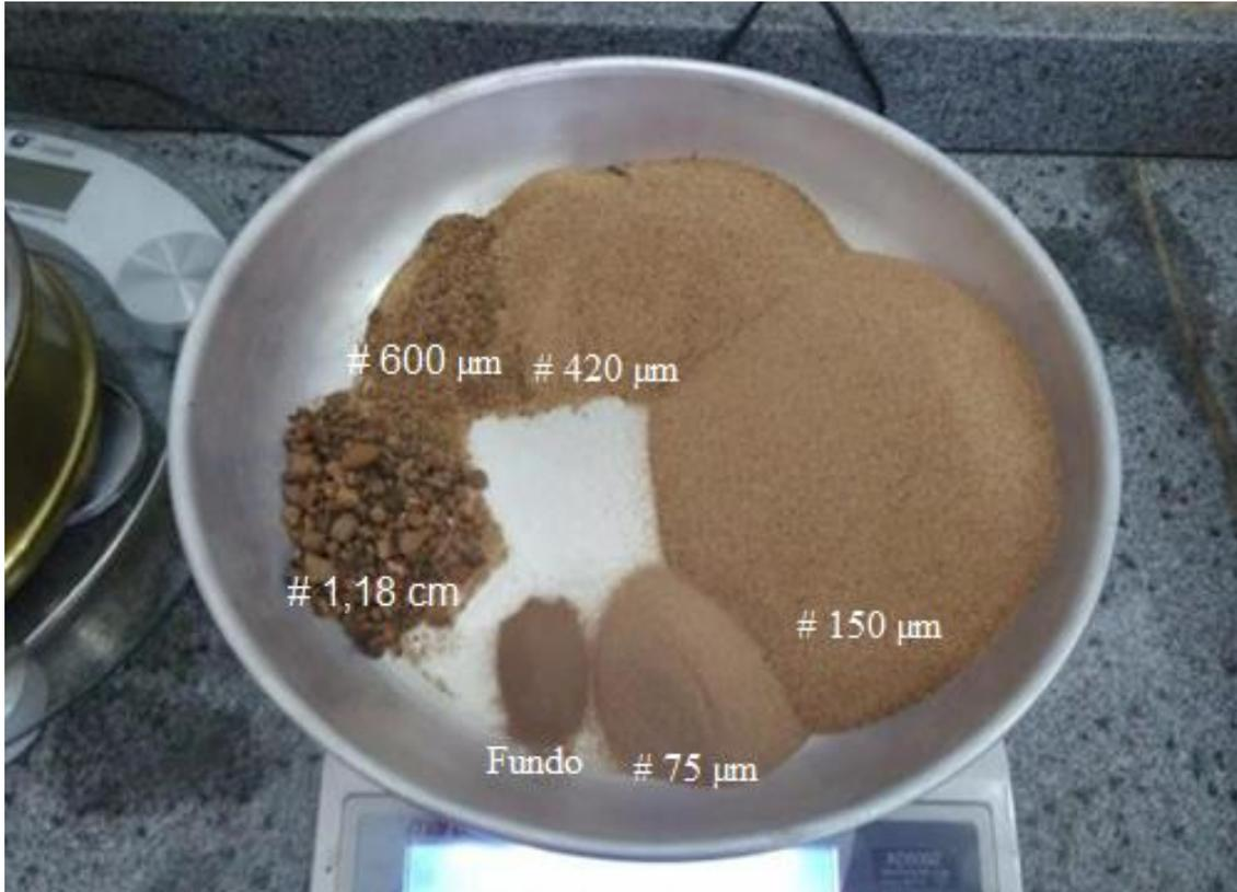
**Figura 5** – Separação massa retida agregado miúdo.
