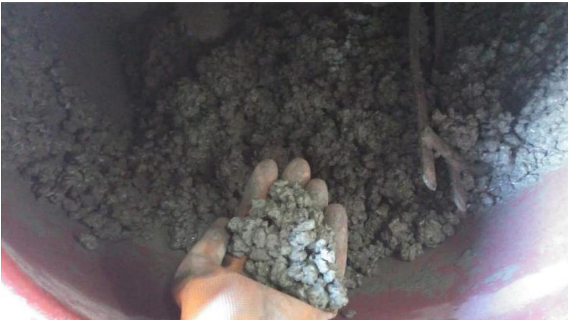
**Figura 24** – Consistência do concreto.
