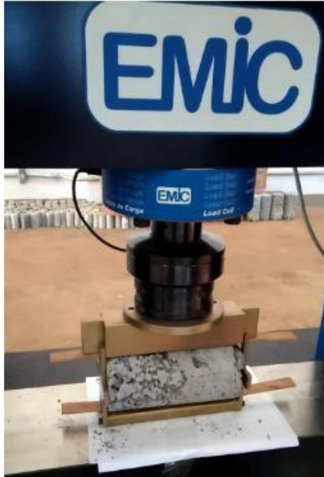
**Figura 27** – Rompimento corpo de prova.
