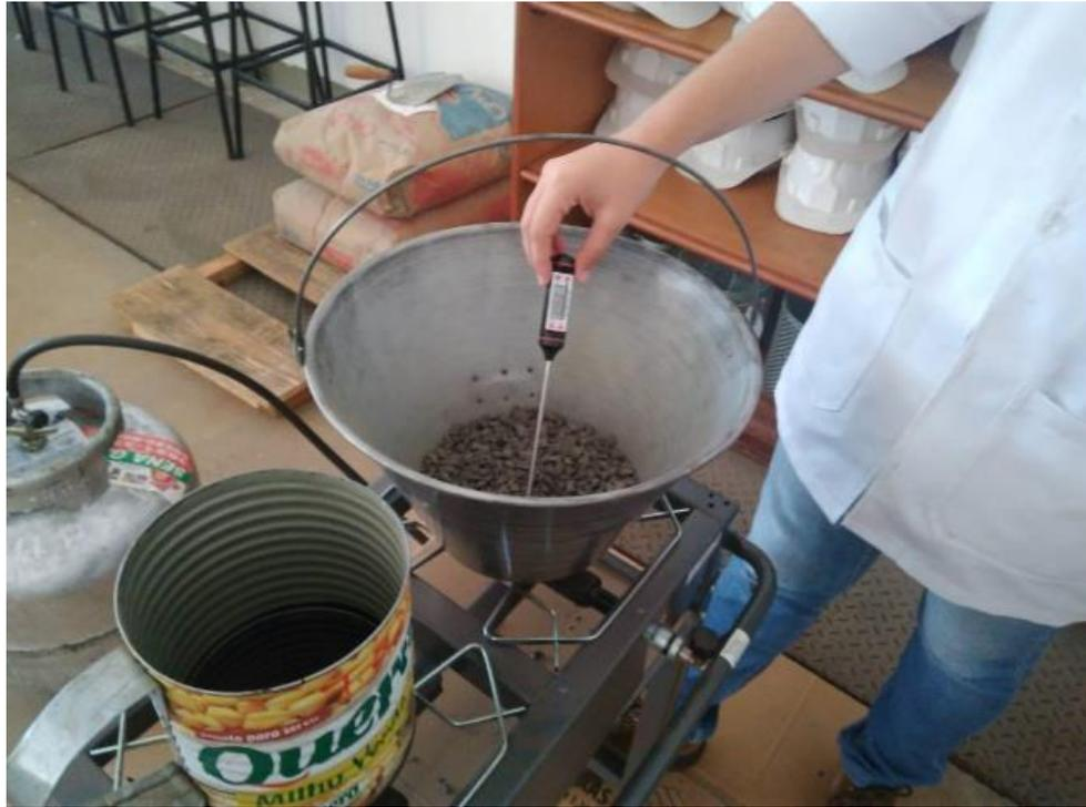
**Figura 14** – Processo de aquecimento CAP e Brita.
