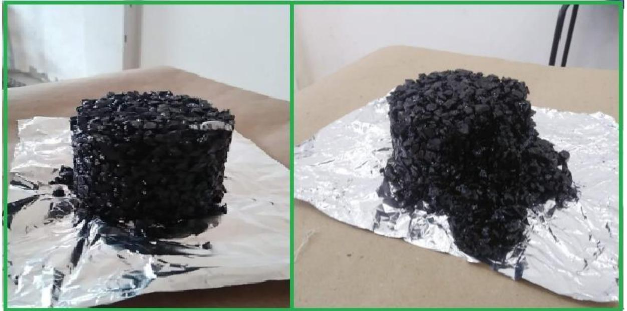
**Figura 18** – Corpo de prova estável e instável.
