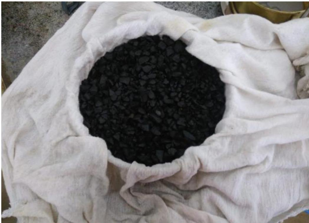
**Figura 7** – Preparação pesagem superfície saturada seca (úmido).
