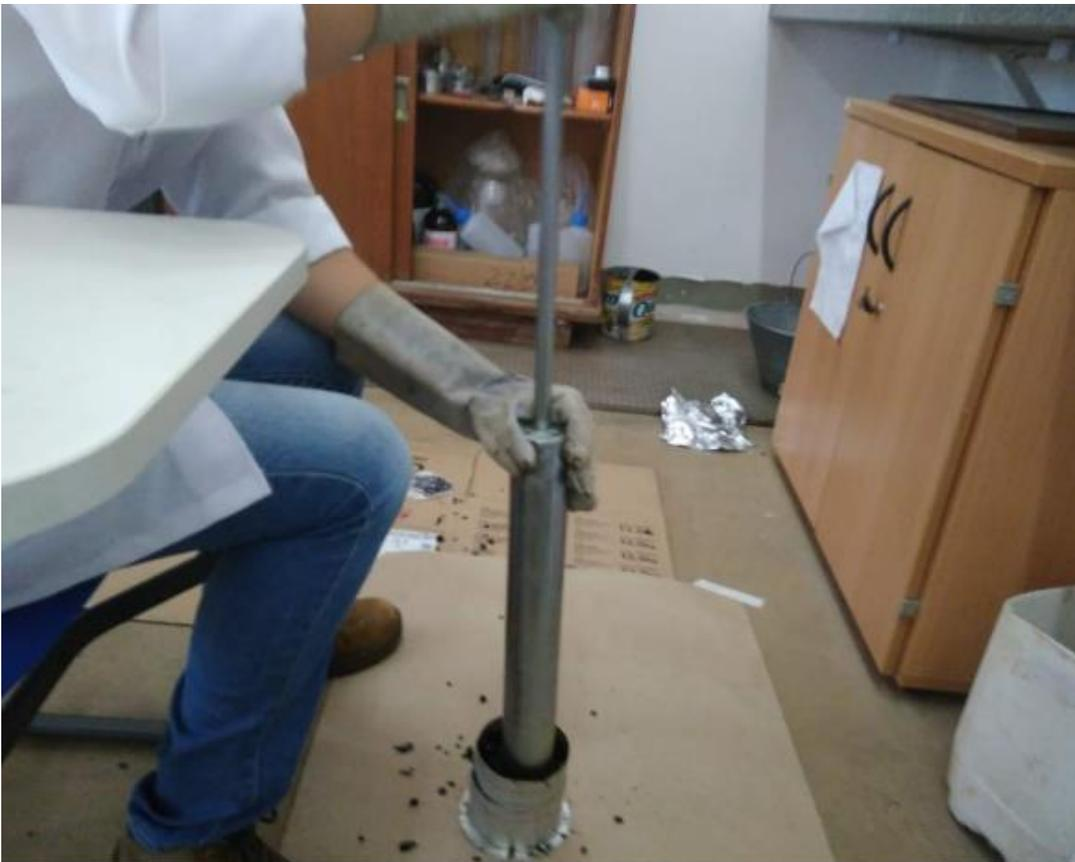
**Figura 17** – Compactação mistura asfáltica.
