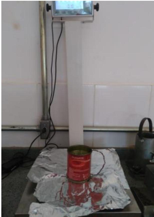
**Figura 15** – Pesagem materiais – CAP aquecido.
