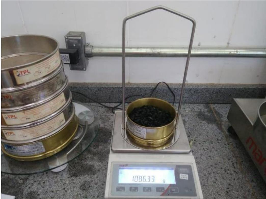
**Figura 6** – Pesagem agregado úmido.
