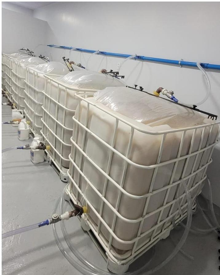
**Figura 7.**Bactérias e Fungos no processo de multiplicação- Sistema Solatus. Arquivo pessoal (2024).
