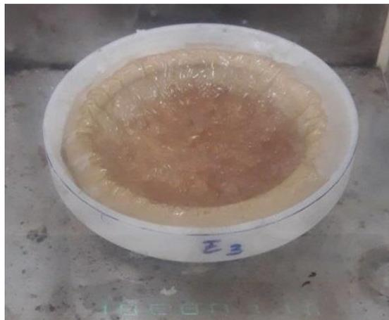
Figura 8: UR2 Umidade relativa dentro da célula de permeabilidade mantida pela solução 2
