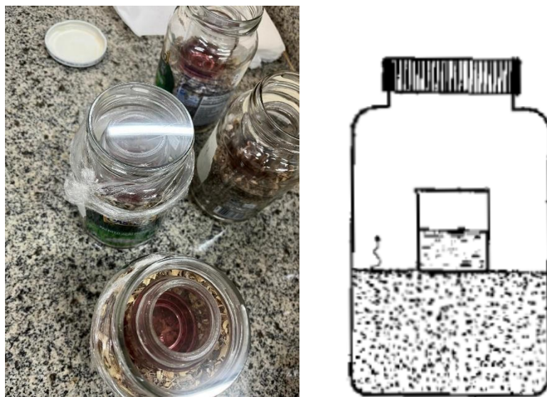
Figura 1 – Recipiente preparado para determinação da amônia volatilizada e esquema da metodologia utilizada.
