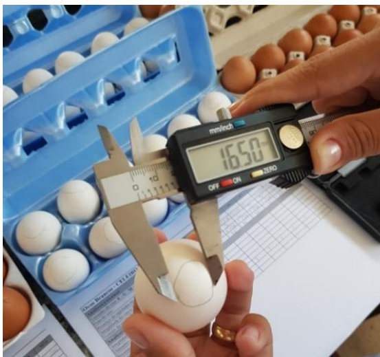
Figura 5 - Mensuração da câmara de ar com paquímetro digital.
