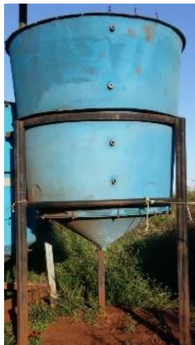
Figura 3. Composteira desenvolvida pela EMBRAPA com detalhes dos orifícios utilizados para aferir temperatura e umidade
