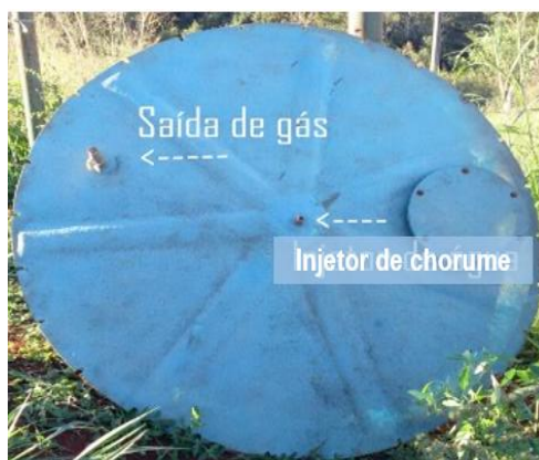
Figura 4. Elemento de saída de gás e injeção de chorume localizados na tampa da composteira
