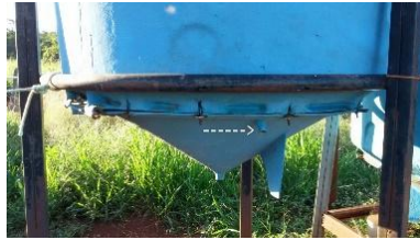
Figura 5. Detalhe da saída de gás e chorume
