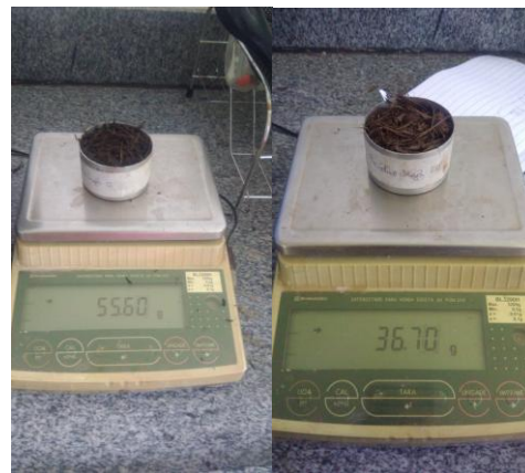
Figura 6. Método para aferir a umidade do composto
