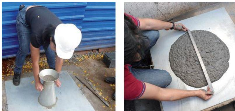
Figura 23 - Exemplificação do teste de espalhamento (*Slump Flow*).
