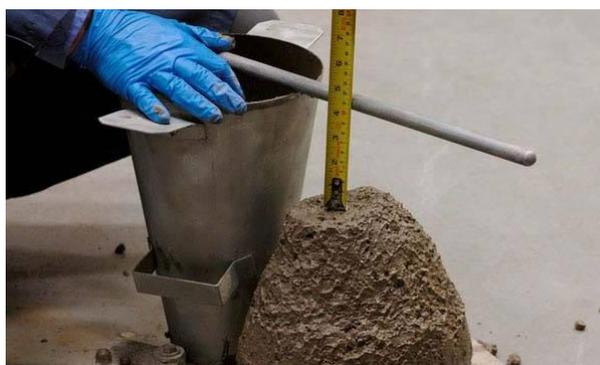
**Figura 22** – Exemplificação do teste de abatimento do tronco de cone (*Slump test*).
