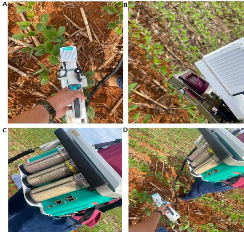
**Figura 4:** (A) e (B) Pinça do analisador de gases por infravermelho (IRGA); (C) Console e painel do IRGA; (D) Conjunto completo, pinça e console.
