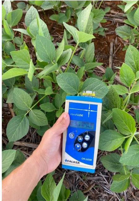
**Figura 3:** ClorofiLOG1030<sup>®</sup> (Falker<sup>®</sup>, Porto Alegre, Brasil) - Medidor eletrônico do teor de clorofilas.
