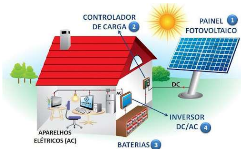
Figura 1.3 Componentes de um sistema de fotovoltaico off-grid .
