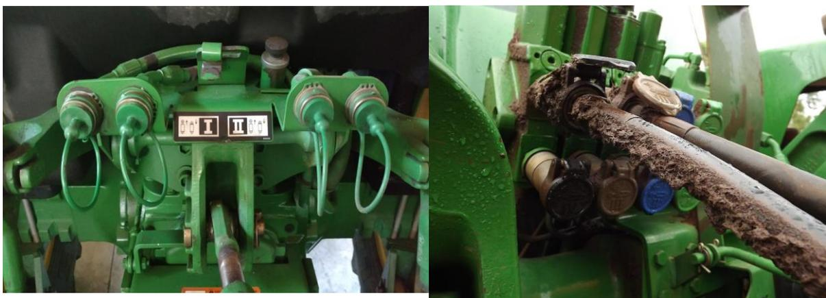
**Figura 1:** Sistema hidráulico (foto à esquerda) e vazamento de óleo mineral lubrificante no sistema hidráulico (foto à direita). Fonte: Garcia, 2020.
