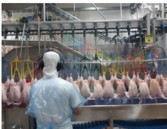
Figura 8: Sala de Evisceração do abatedouro da SSA – nórea colorida, transferindo a carcaça até a máquina extratora de cloaca, 2025.
