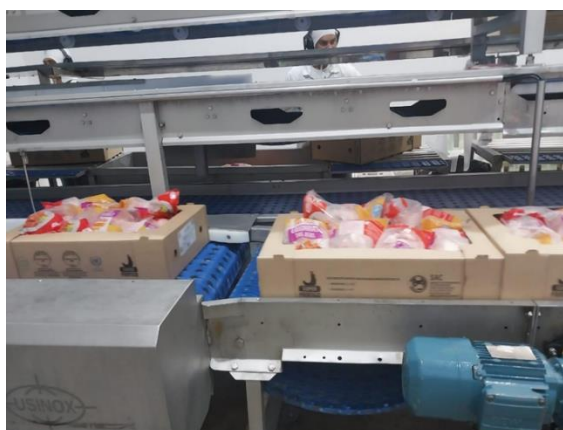
Figura 14: Esteira da Padronização dos produtos da SSA – conferência das conformidades das caixas e embalagens, pesagem, detecção de metais, 2025.
