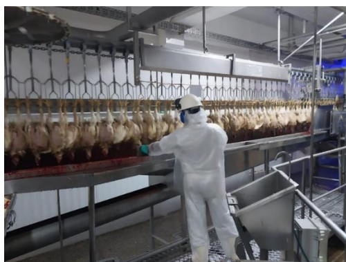
Figura 7: Sala de Sangria do abatedouro da SSA – repasse das carcaças, utilizando a faca esterilizada para a sangria daquelas que o aparelho não realizou, 2025.
