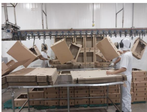
Figura 12: Setor de Embalagem Secundária da SSA – Montagem de caixas de papelão, 2025.
