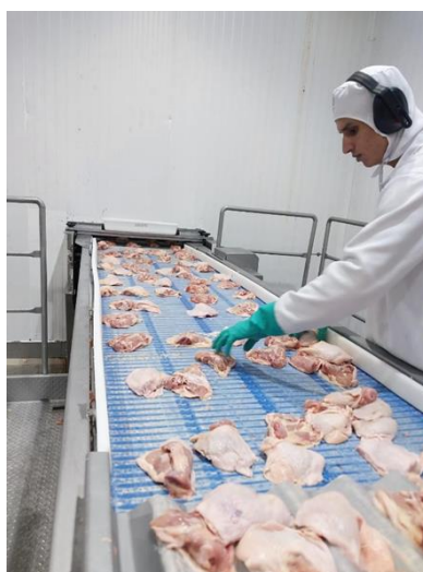
Figura 13: Esteira que levava os cortes para o congelamento da sala de IQF da SSA – Setor de Cortes e Recortes, 2025.
