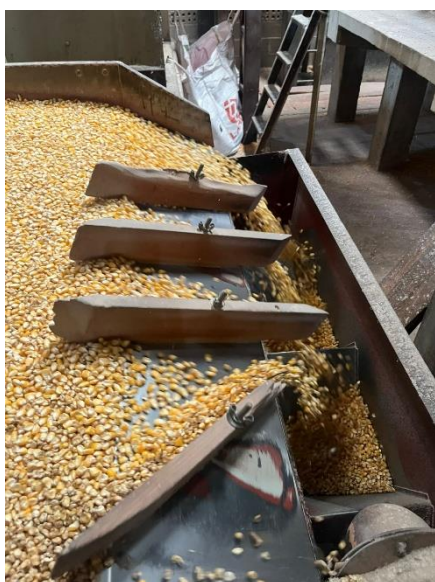
Figura 4: Classificação das sementes de milho por densidade. Fonte: Autor.
