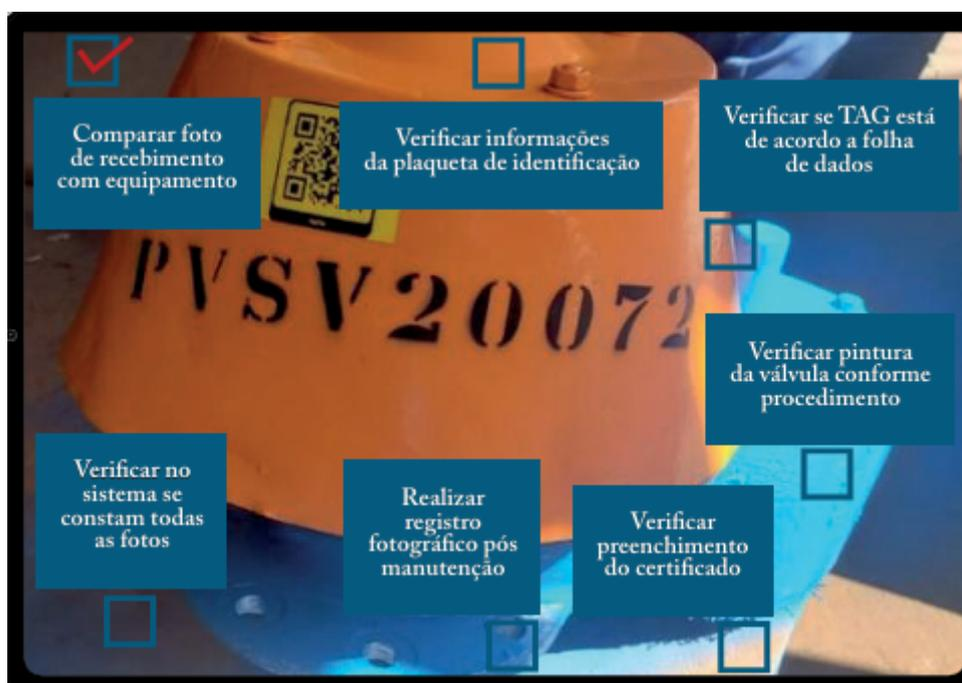
Figura 6: Instruções para a inspeção de válvulas de segurança, após a leitura do marcador.
