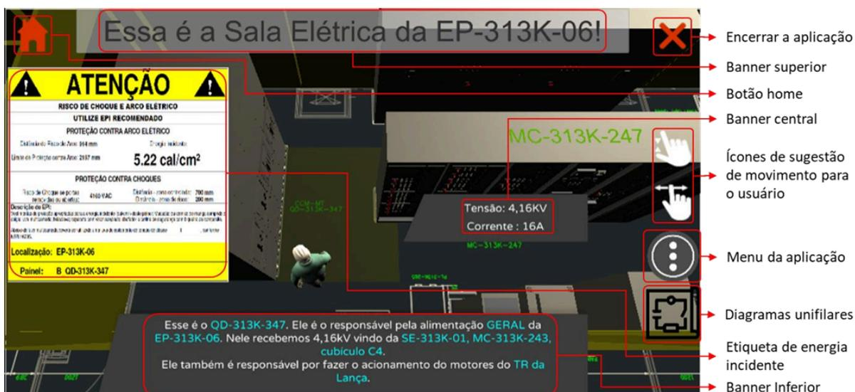
Figura 5: Distribuição dos componentes para visualização do operador após a leitura de uma *TAG*.
