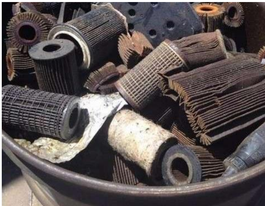
Figura 6: Resíduos contaminados com hidrocarbonetos.
