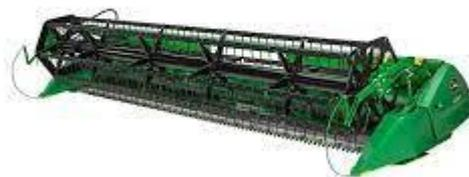
**Figura 2:** Plataforma de soja para colhedora de grãos. Fonte: Deere Company (2024).
