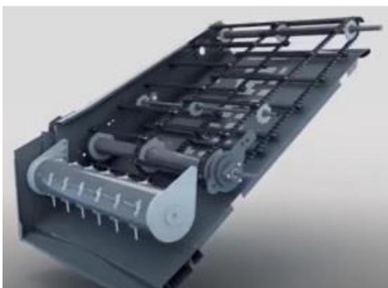
**Figura 3:** Sistema de alimentação de uma colhedora de grãos. Fonte: Mantoni (2020).
