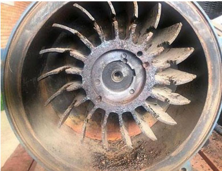
**Figura 4.** Danos causados a um rotor por cavitação. Fonte: Simscale (2025)
