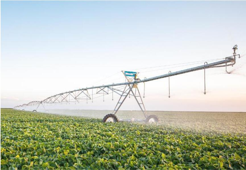
**Figura 1.** Pivô central em funcionamento. Fonte: Central Irrigação (2025).
