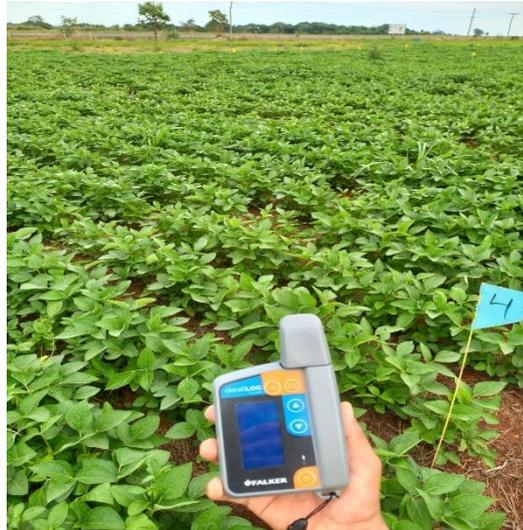
**Figura 3:** Clorofilog portátil Falker.
