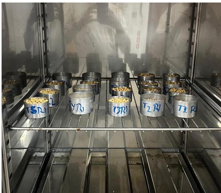
**Figura 7.** Condicionamento na estufa a 105°C
