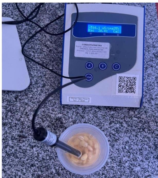
**Figura 5.** Medição da condutividade elétrica
