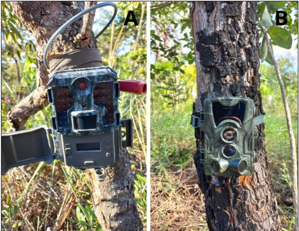
Figura 2. Modelos de armadilhas fotográficas utilizadas nas áreas amostradas. A: Câmera *trap*, modelo 20MP Bushnell prime L20 Low Glow; B: Câmera *trap*, modelo Suntec Hc 801A-LI 16 MP. Fonte: Fonte: (Autores, 2024).
