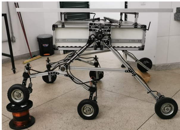
Figura 31 - Mecanismo rocker-bogie em ação.
