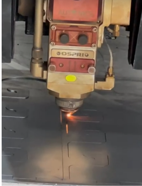
Figura 21 - Corte a laser das chapas de união.
