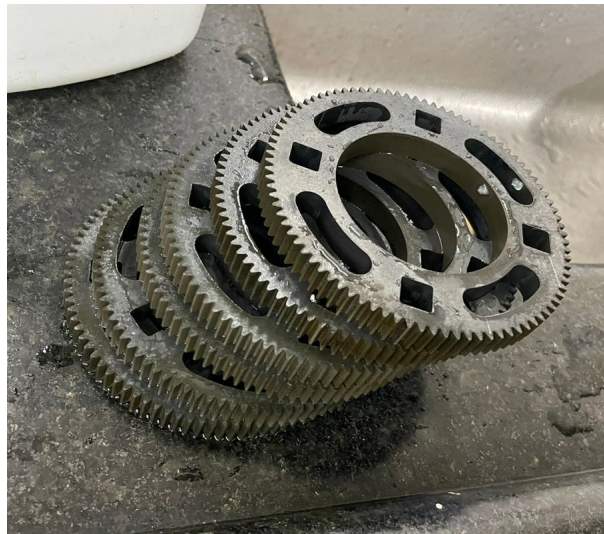
Figura 30 - Engrenagens movidas finalizadas.
