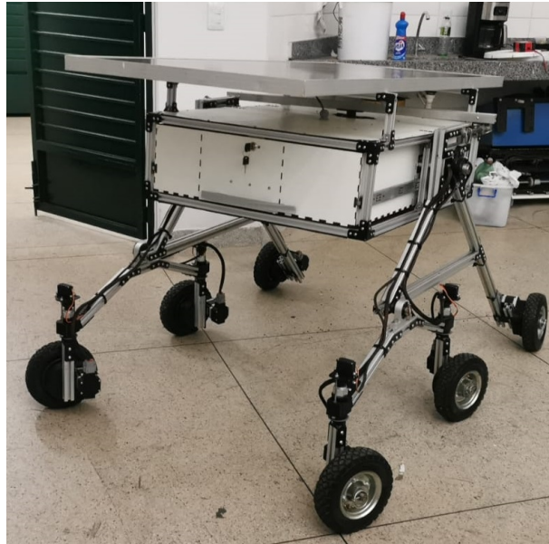
Figura 43 - Rover montado e com as rodas do bogie esterçadas conforme Diagrama de Ackermann.
