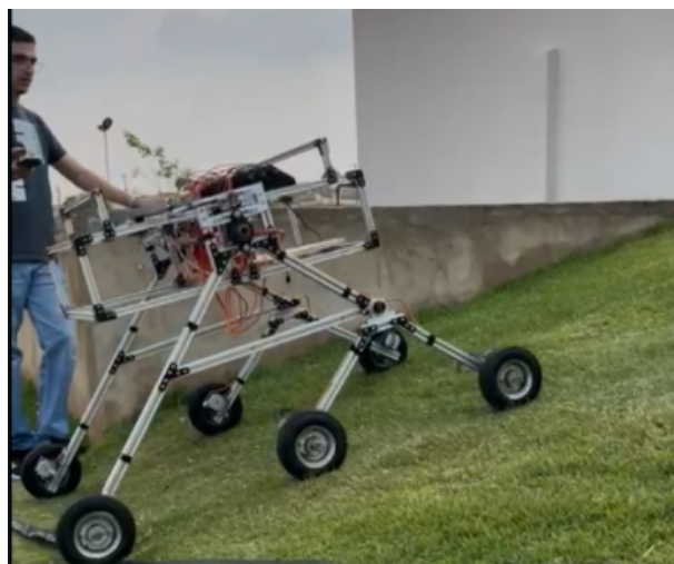
Figura 45 - Ensaio do rover em terrenos inclinados.
