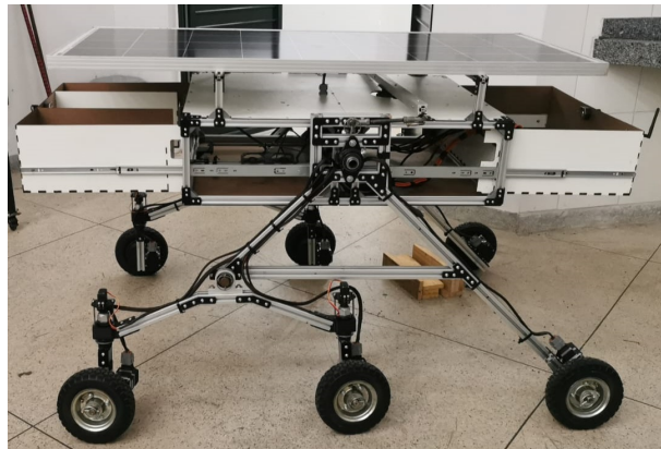
Figura 33 - Compartimentos deslizantes completamente expandidos.
