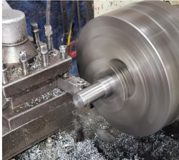
Figura 22 - Usinagem dos eixos do rover .
