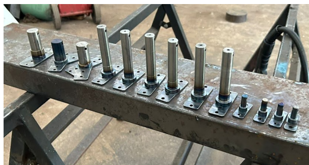
Figura 29 - Eixos usinados já soldados às chapas de união.
