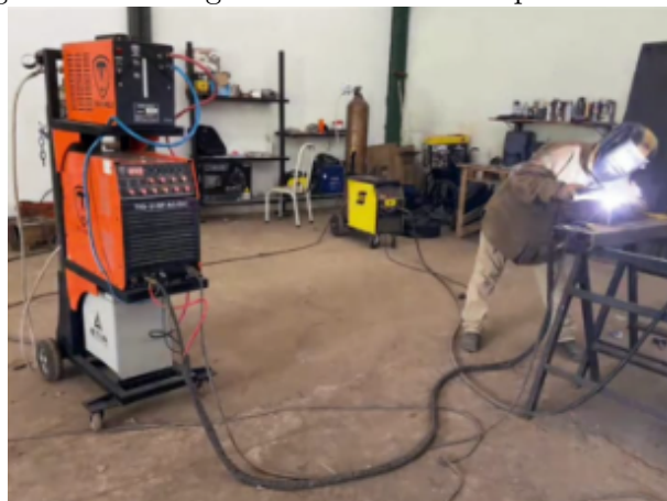
Figura 23 - Soldagem dos eixos nas chapas de fixação.
