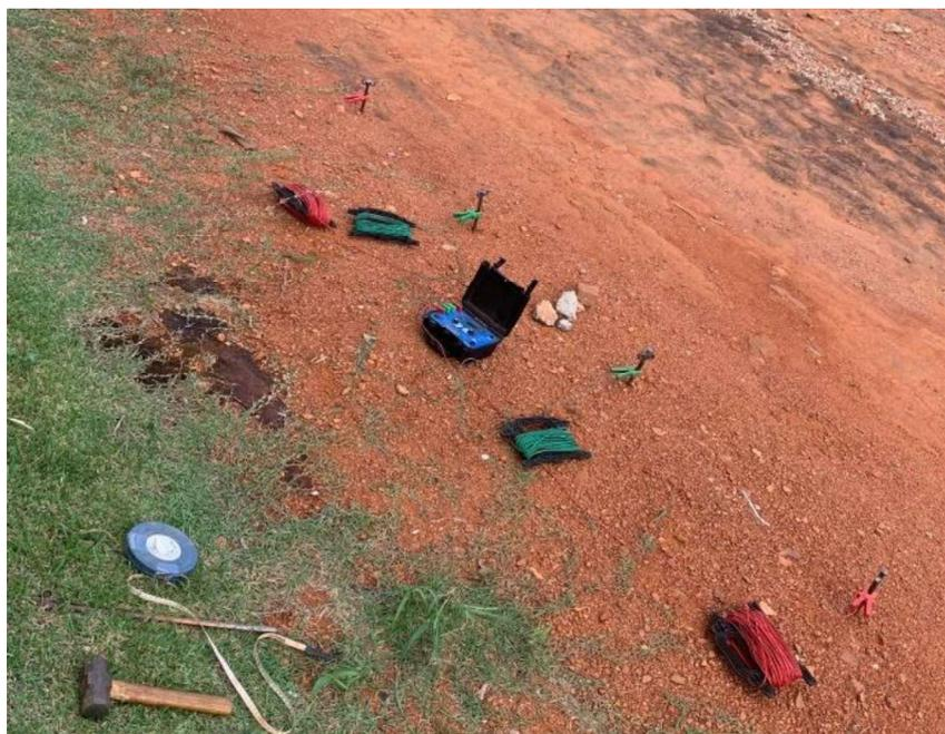
Já a Figura 12 traz informações sobre os valores lidos pelo equipamento após ter sido inserida as quatro hastes no solo dentro dos pontos previstos e descritos anteriormente.
