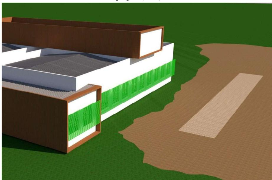
Podemos inferir então que para a região de interesse analisada, devemos então instalar 11 hastes de cobre de 2,4 metros de comprimento e diâmetro de ½”, sendo interligadas por condutor de cobre trançado de 50 mm<sup>2</sup> ao qual deve conectar todas as hastes por meio de
