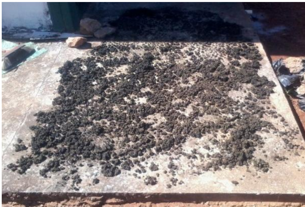
Figura 10 Processo de secagem natural lodo seco.
