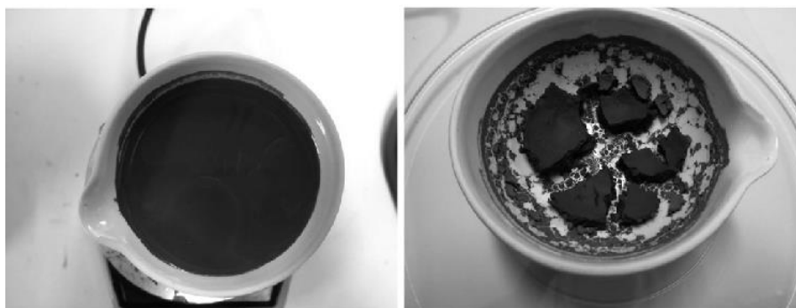
Figura 8 Amostra de lodo de esgoto seca em estufa térmica.
