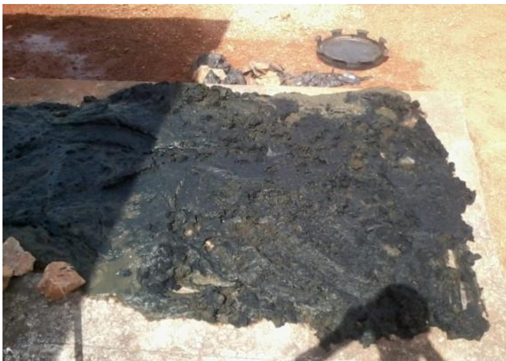
Figura 4.49 Processo de secagem natural lodo úmido
