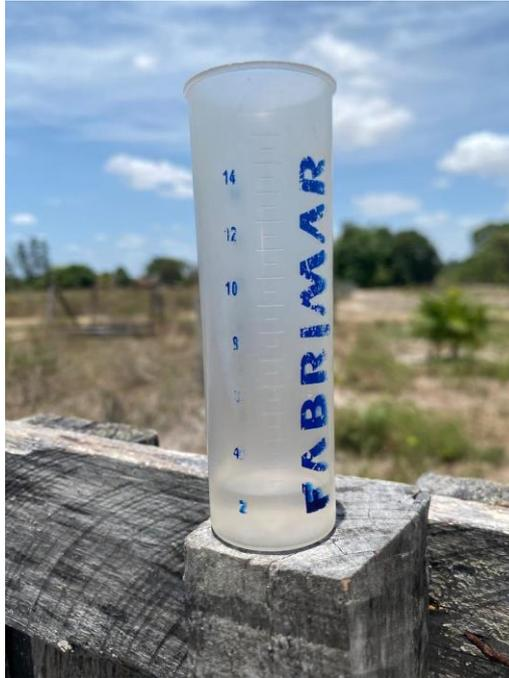
Figura 7 - Proveta para coleta de volume de água para o cálculo do CUD
