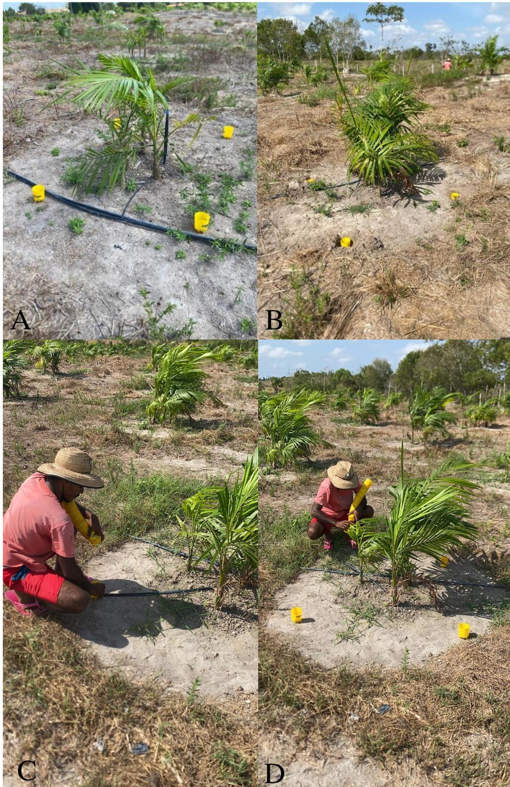
Figura 6 - Distribuição das canecas para o ensaio do CUD (A, B, C e D)
