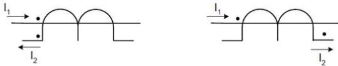
Figura 12: Marcas de Polaridade e Sentido das Correntes. Fonte: KINDERMANN, 2005.
