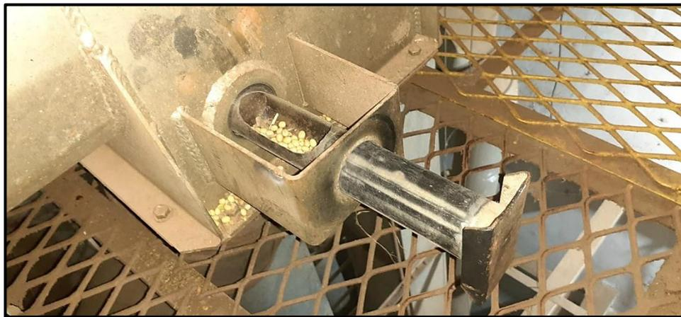
**Figura 10:** Local de coleta das amostras para determinar a umidade de saída. Fonte: (Autor, 2024)
