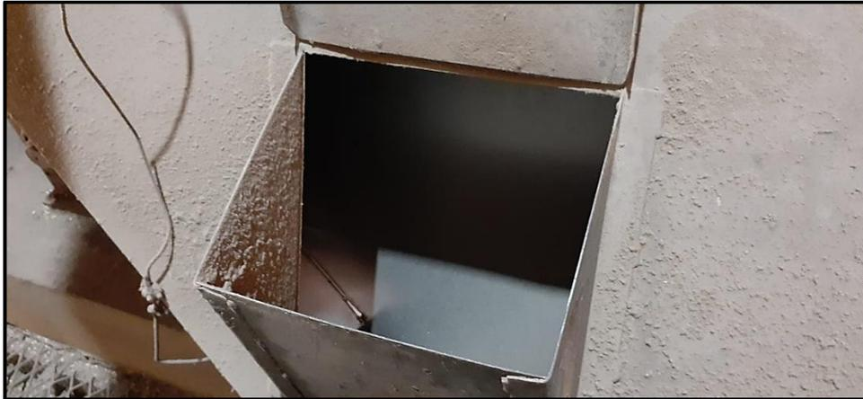
**Figura 9:** Local de coleta das amostras para determinar a umidade de entrada. Fonte: (Autor, 2024)
