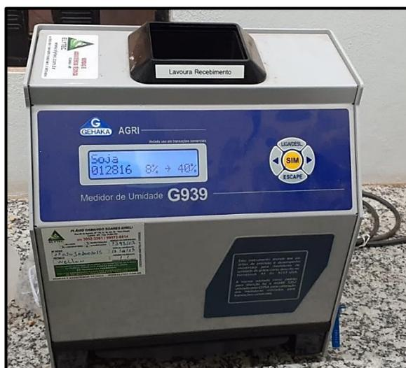
**Figura 11:** Determinador de umidade. Fonte: (Autor, 2024)
