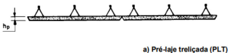
Figura 1. Pré-laje treliçada. Fonte: NBR 14860:2002.
