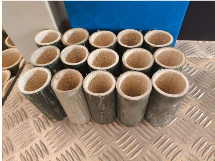
**Figura 9.** Corpo de prova para ensaio de compressão.
