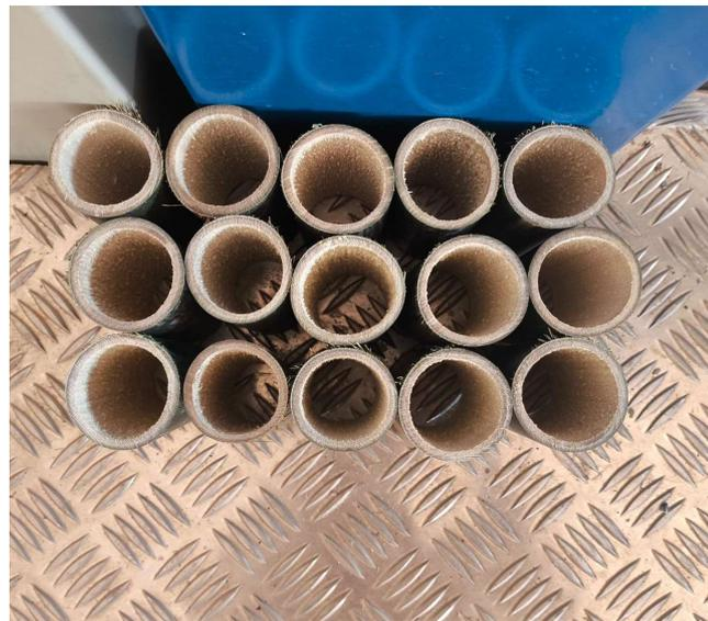
**Figura 11.** Corpo de prova para ensaio de cisalhamento.
