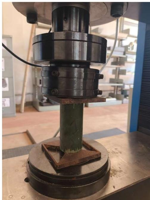
**Figura 15.** Ensaio de cisalhamento.
