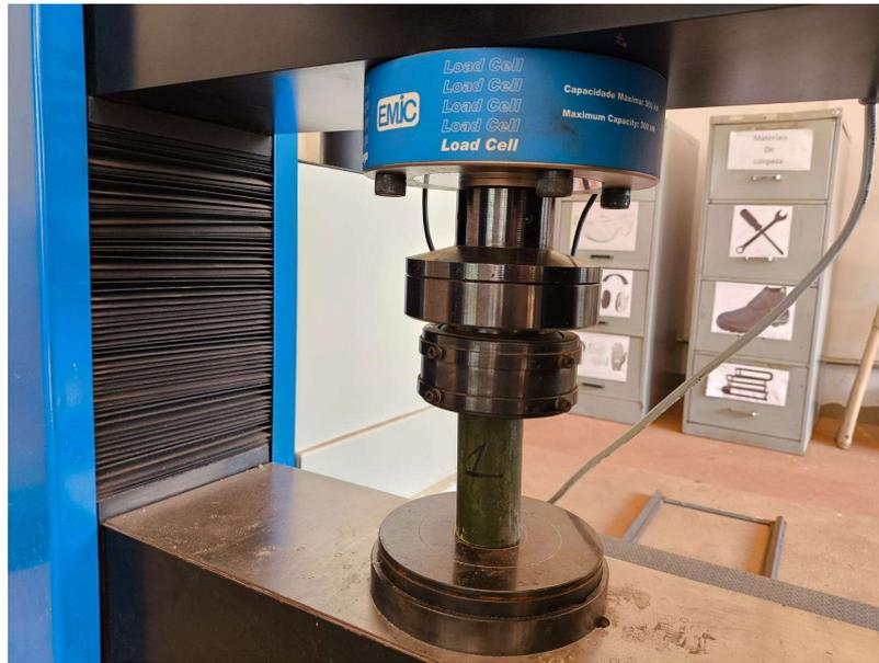
**Figura 13.** Ensaio de compressão.
