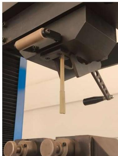
**Figura 12.** Ensaio de tração.
