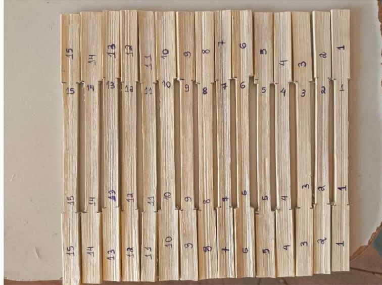
**Figura 10.** Corpo de prova para ensaio de tração.
