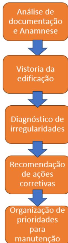
**Figura 8:** Fluxograma de ações para inspeção predial.
