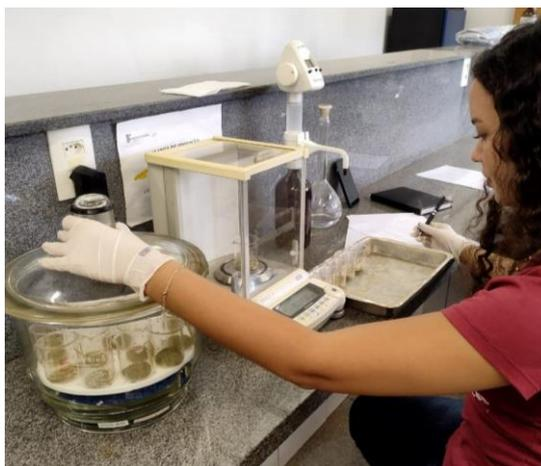
Figura 10: Pesagem das amostras após secagem a 105 °C
