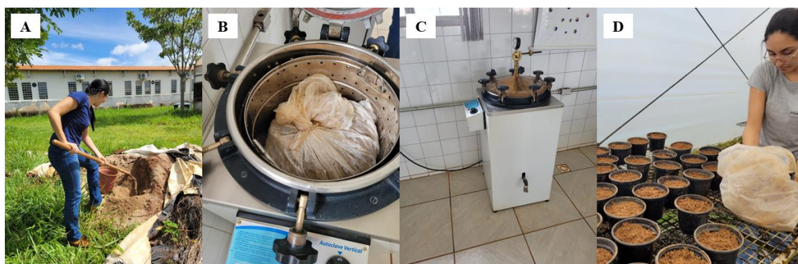
Figura 6. Preparo do solo. A. coleta do solo. B e C. autoclavagem do solo. D. preenchimento dos vasos com solo autoclavado.
