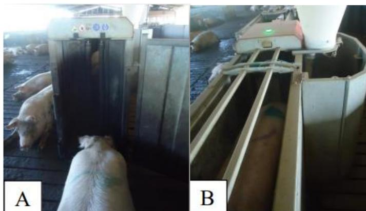
Figura 10- A – comporta da estação eletrônica e B – mecanismo de detecção
