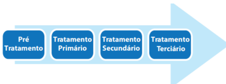
Figura 05 - Níveis de tratamento do esgoto.
