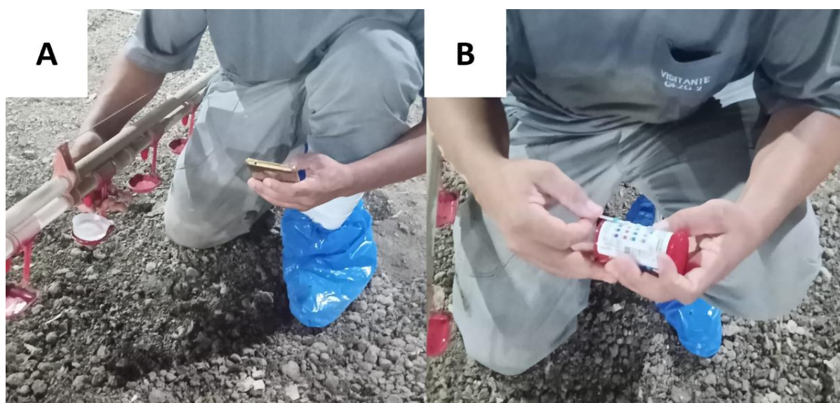
Figura 8- Qualidade da água dentro dos aviários. A: Medição da pressão; B: Avaliação do pH. Fonte: Arquivo Pessoal
