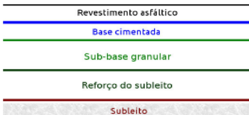
FIGURA 3 – Camadas de um pavimento semirrígido FONTE: DER-PR, 2008
