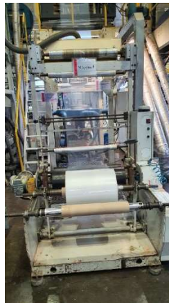
Figura 7 - Torre de extrusora
