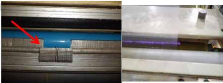
Figura 11 - Pinças e estação de tratamento corona
