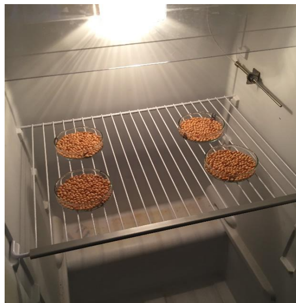
Figura 1. Determinação de massa inicial das subamostras (a) e subamostras submetida as temperaturas na BOD (b).
