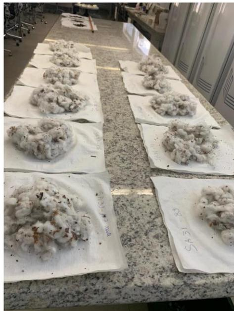
**Foto 9.** Preparação das amostras para deslntamento em laboratório.
