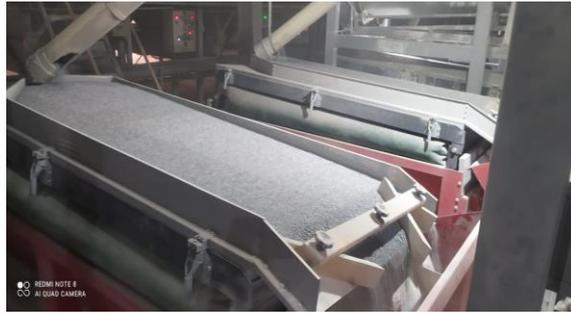
**Foto 6.** Mesa densimétrica, equipamento utilizado para a triagem das sementes separando material inerte, leves e densos; funciona por meio de injeção de ar e movimentos vibratórios.
