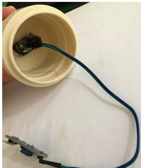
Figura 13. (A) Sensor de umidade do solo hl-69 com ilustração de onde se deve passar o silicone para vedação. (B) Sensor de umidade do solo vedado e soldado na tampa do tubo PVC.
