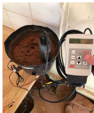
Figura 9. (A) Leitura dos valores brutos dos sensores controlados pelo Arduino. (B) Leitura do sensor TDR, de referência.
