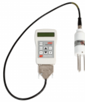
Figura 7. Sensor TDR, de referência.
