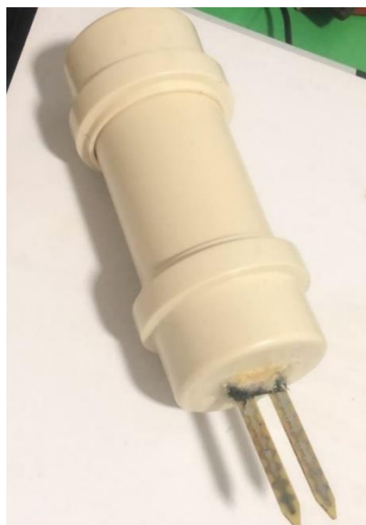
Figura 32. Protótipo de sensor de umidade do solo de baixo custo.
