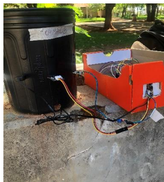
Figura 9. (A) Leitura dos valores brutos dos sensores controlados pelo Arduino. (B) Leitura do sensor TDR, de referência.
