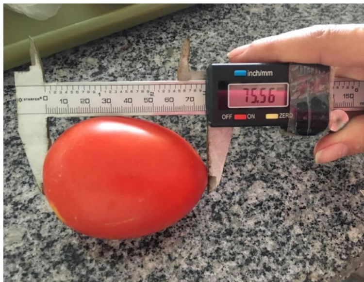
Figura 24. Avaliação do diâmetro longitudinal do fruto, utilizando paquímetro digital.
