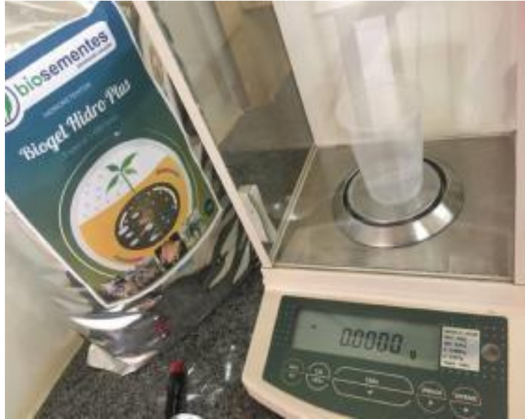
Figura 1. Balança de precisão utilizada em pesagens de doses de hidrogel e fertilizantes.
