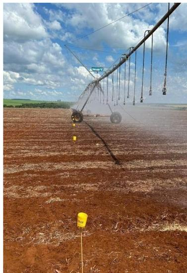
**Figura 10:** Equipamento passando sobre kit coletor CUC. Fonte própria (2023)
