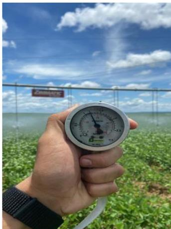
Figura 06: Pressão na ponta do equipamento. Fonte: (Própria. 2024).
