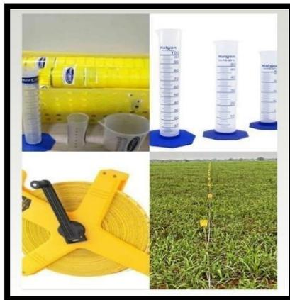
**Figura 07:** Copo coletor, Proveta volumétrica, trena e kit coletor CUC montado. Fonte: próprio autor (2023).
